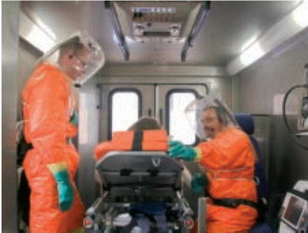
Abb. 4: Patient und Besatzung in der Patientenkabine (Übung). Die Oberflächen bestehen aus Edelstahl und sind leicht zu desinfizieren. Im Inneren befindet sich nur die tatsächlich für den Transport benötigte medizinische Ausrüstung. (Foto: G. Lichtfuss)
