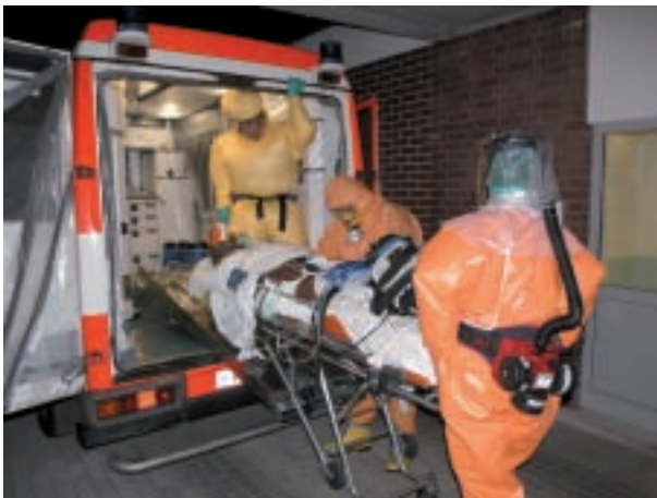
Abb. 7: Ausschleusen eines Patienten mit Lassa-Fieber am Behandlungszentrum Frankfurt am Main. Bei diesem SIT wurde ein temporärer I-RTW eingesetzt. Die Innenwände der Patientenkabine sind mit Kunststofffolie verkleidet. (Foto: Feuerwehr Frankfurt am Main)
