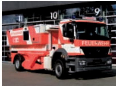
Abb. 6: Ein I-RTW der neuesten Generation auf Wechselladerbasis (Frankfurt am Main). Der Patienten-Container kann bereits als autonome Isolier-Behandlungseinheit für eine erste Versorgungsphase verwendet werden. Ein weiteres Einsatzgebiet liegt im Schwerlasttransport extrem adipöser Patienten. (Foto: Feuerwehr Frankfurt am Main)
