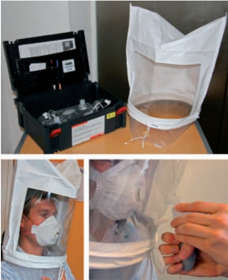
Abb. 2: Der Fit-Test: In den meisten kommerziell erhältlichen Test-Sets ist alles enthalten, was für die Durchführung notwendig ist; bei aufgesetzter Haube wird das Geschmacksstoffaerosol durch eine Öffnung eingesprüht. (Fotos: G. Lichtfuss)
