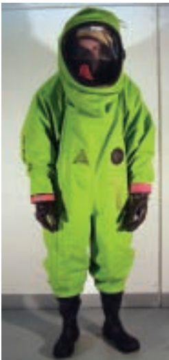
Abb. 9: Chemikalienschutzanzug mit umluftunabhängigem Atemschutz. Das Material des Schutzanzugs ist flüssigkeitsdicht/gasdicht, hält erhöhter mechanischer Belastung stand und erlaubt eine Gesamtkörperdekontamination und ein erweitertes Arbeitsspektrum. Der Anzug kann stärker beansprucht werden. (Foto: D. Friederichs)
