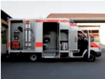
Abb. 5: Ein typischer I-RTW moderner Bauart (Standort Königswusterhausen). Patientenkabine und Fahrerkabine sind strikt voneinander getrennt, technische und medizinische Ausrüstung in außenliegenden Ladefächern verstaut. Fahrzeuge diesen Typs werden auch außerhalb von SIT's eingesetzt. (Foto: C. Bartels)
